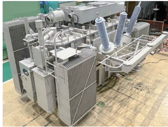
図1 全装可搬型20MVA LRTの外観
